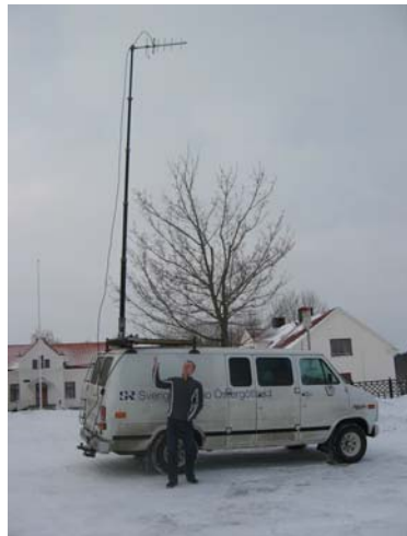
Fig. 5.4 OB-bussen i Norrköping, utrustad med digital Aprisa XE utrustning.
