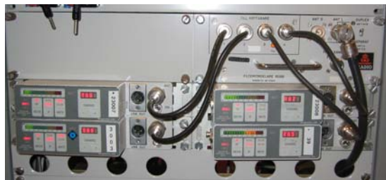
Fig. 2.1 Mottagare (4 st) av typen Magnetic 850, kopplade till filter och fördelarförstärkare
