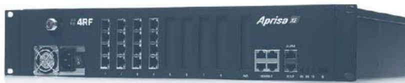
Fig. 5.1 Aprisa XE sändare & mottagare med E1-anlutningar till vänster och 4 st Ethernet anlutningar till höger.
